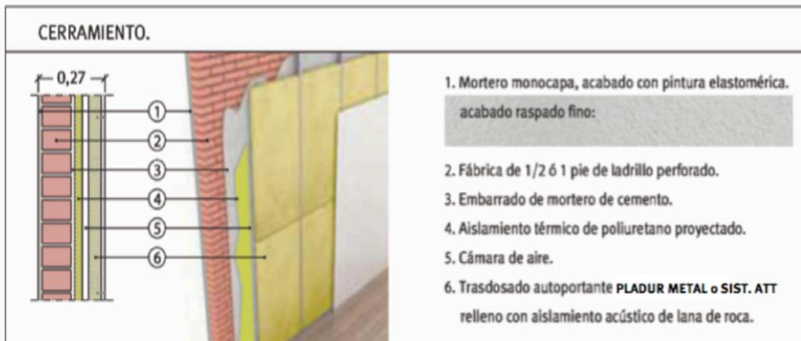
En las zonas comunes (como el portal), el trasdosado autoportante se sustituirá por tabique de ladrillo hueco doble (5cm) con guarnecido y enlucido de perlita (1,5 cm).
