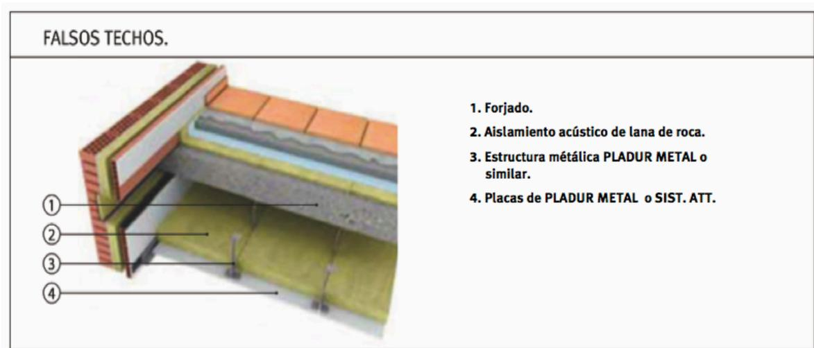
En zonas comunes se colocará el falso techo continuo descrito anteriormente sin aislamiento acústico, excepto en aquellas zonas en contacto con viviendas (como el portal) donde sí dispondrá de aislamiento acústico de lana de roca tipo Rockwool de e=4cm.
